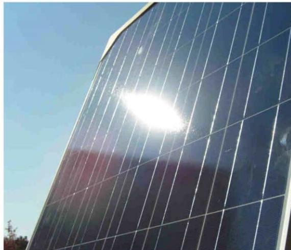
Bündelaufweitung beim Sonnentest eines polykristallinen Moduls,
