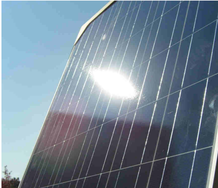
Bündelaufweitung beim Sonnentest eines polykristallinen Moduls, Einstrahlwinkel ca. 20°, Reflexleuchtdichte ca. 8 Mio cd/m 2
